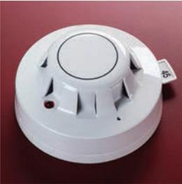
El Discovery UL Ionization Smoke Detector utiliza el principio de cambios en la ionización del aire, esto se logra utilizando un papel metálico radiactivo de baja actividad que irradia sobre el aire que se encuentra en las cámaras de humo dentro del aparato generando un flujo de corriente base. En el caso de que entre humo a las cámaras, el flujo de corriente se reducirá lo que generará una alarma.
