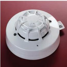
El Discovery UL Detector Multisensor consta de sensores ópticos para humos y resistivos para temperatura, cuyos resultados se combinan para dar el valor analógico final. Como resultado, el Multisensor es útil en una amplia gama de aplicaciones y es altamente inmune a presentar falsas alarmas.
