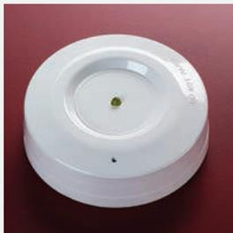
El XP95A Isolator se coloca en intervalos dentro del circuito de detectores, con lo cual se asegura que, en el caso de un corto circuito, sólo la sección entre los aisladores sea la afectada. Cuando el corto circuito se elimina, los aisladores automáticamente restauran la energía e información de la sección aislada.
