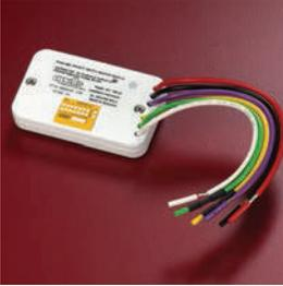
El XP95A Mini Priority Switch Monitor Module está diseñado para supervisar el estado de uno o más polos y contactos de relevo libres de voltaje e informar el estado al equipo compatible de control analógico Apollo. También puede colocar una señal en el circuito de detectores para proporcionar una advertencia temprana si un dispositivo como un registro se encuentra operando.
