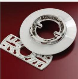
La Series 65A End of Line Relay Base (EOL) esta destinada para el uso de circuito de 4 cables y dispone de 2 conjuntos de salidas de relevo y un supervisor de corriente del sistema de relevo.
