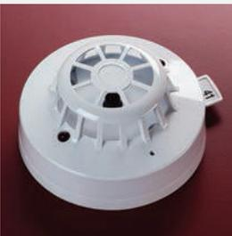
El Discovery UL Heat Detector se distingue por su cubierta que aporta baja resistencia al flujo de aire y tiene un sencillo sensor resistivo que mide la temperatura alrededor del detector.
